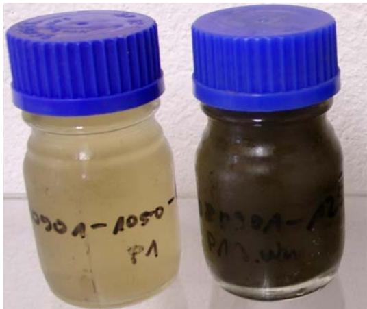
Abbildung 7: Überführung der Schadstoffe in das Prozesswasser (links vor und rechts nach der Bodenwäsche).
