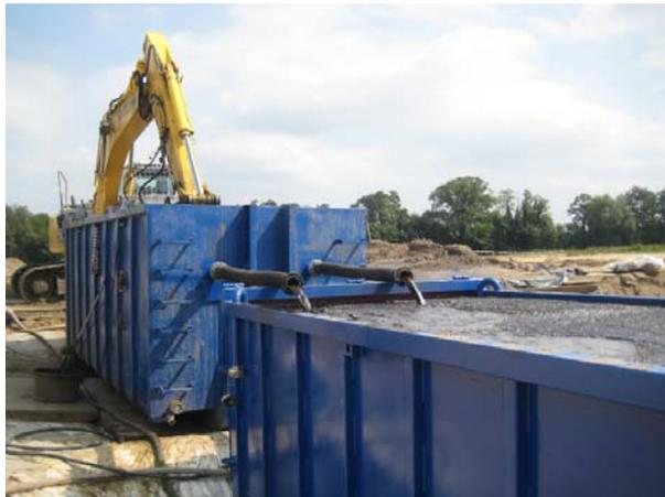
Abbildung 8: OSBO®-On-Site-Bodenwäsche im Spezialcontainer mit nachgeschalteter multifunktionaler Trennstufe.
