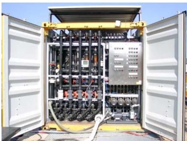
Abbildung 11: Biologisch-oxidative Prozesswasserreinigung.
