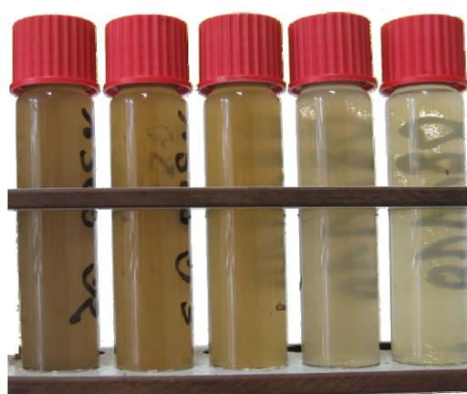
Abbildung 12: Prozesswasserproben vor, während und nach der biologisch-oxidativen Reinigung.
